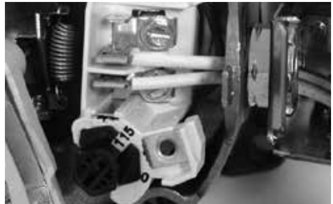
Figura 8: Tensión configurada para 115 V, tipo cuadrante.
