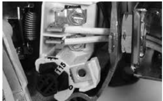
Figura 8: Tensión configurada para 115 V, tipo cuadrante.
