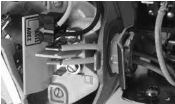
Figura 6: Tensión configurada para 115 V, tipo ficha.
