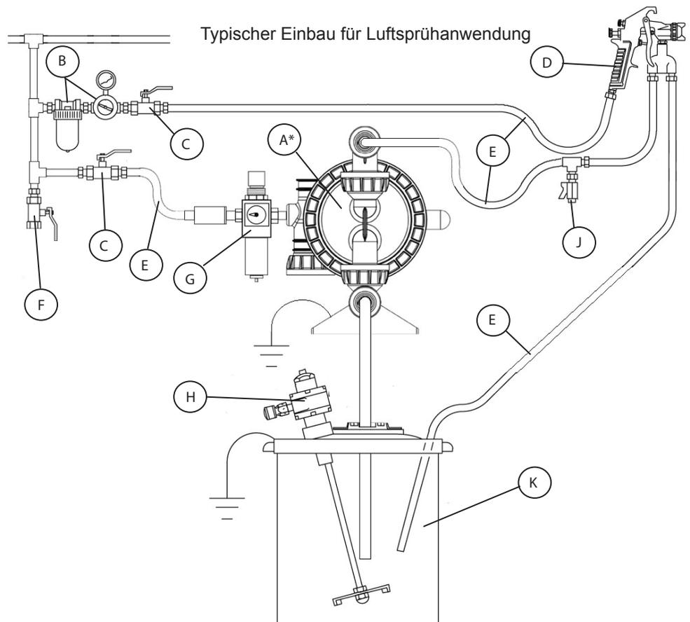
\*HINWEIS: Die Pumpe mit Halterungen und Befestigungsteilen, die für die Anwendung geeignet sind, sicher an einer stabilen Montagefläche befestigen.
