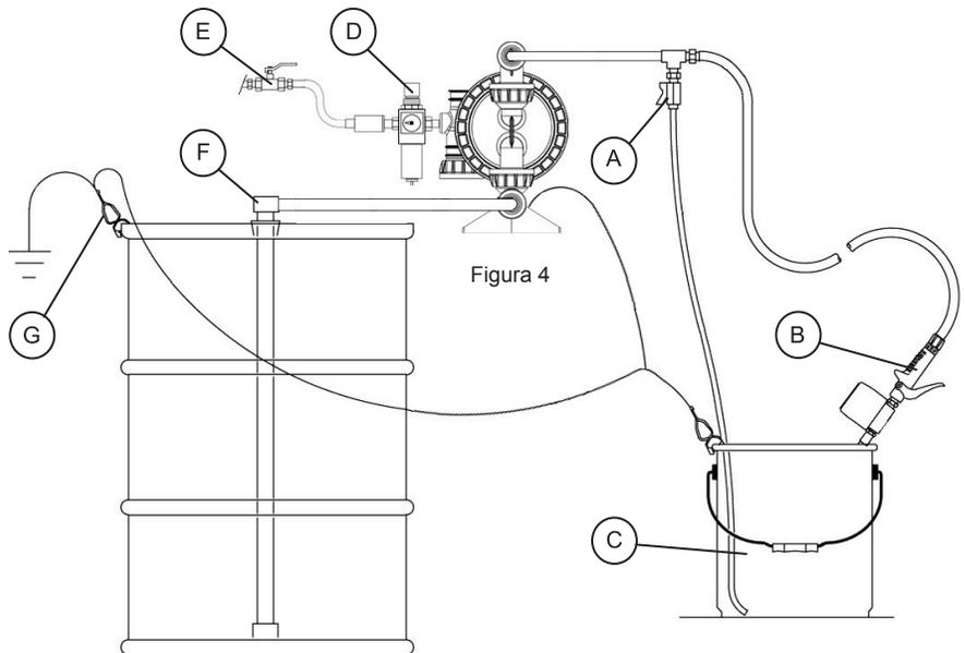
**ADVERTENCIA** **¡ADVERTENCIA! APAGADO ADECUADO DE LA BOMBA.** La vida útil del diafragma y del sello se puede ver reducida si se aplica presión de aire al motor de la bomba durante periodos prolongados cuando no se está usando la bomba. Para evitar que esto suceda, se debe instalar una válvula solenoide de 3 vías que alivie automáticamente la presión del motor de aire cuando se complete un ciclo de medición.
