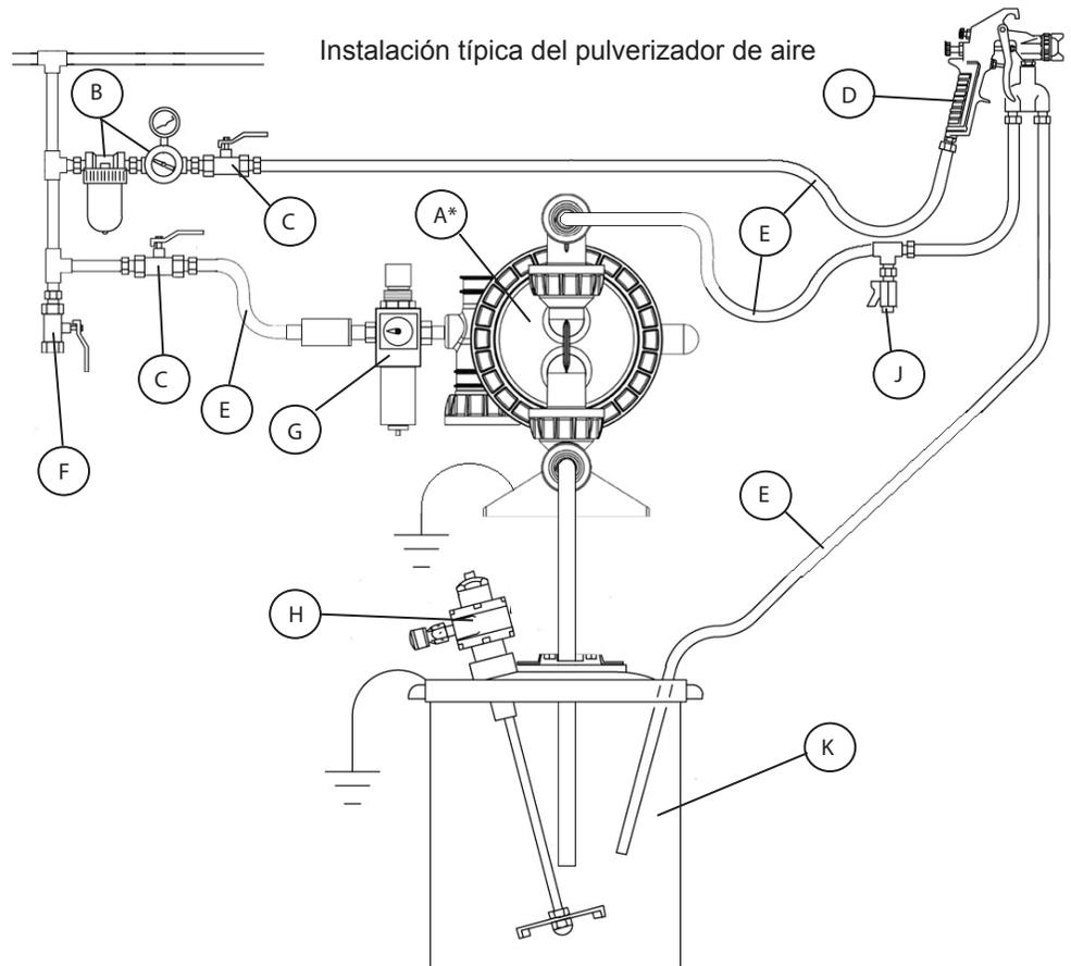
\*NOTA: Monte la bomba de manera segura a una superficie sólida con los soportes y las piezas metálicas de fijación correspondientes para la aplicación.
