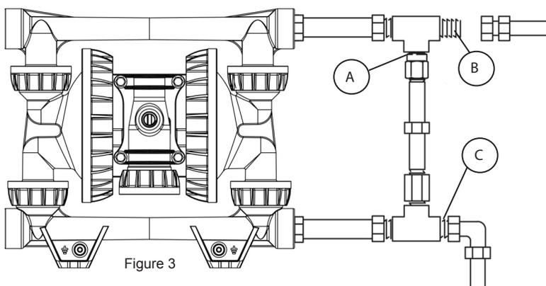
Certains systèmes peuvent nécessiter la pose d'une soupape de décharge de pression au niveau de la sortie de pompe pour éviter une surpression et la rupture éventuelle de la pompe ou du tuyau.
