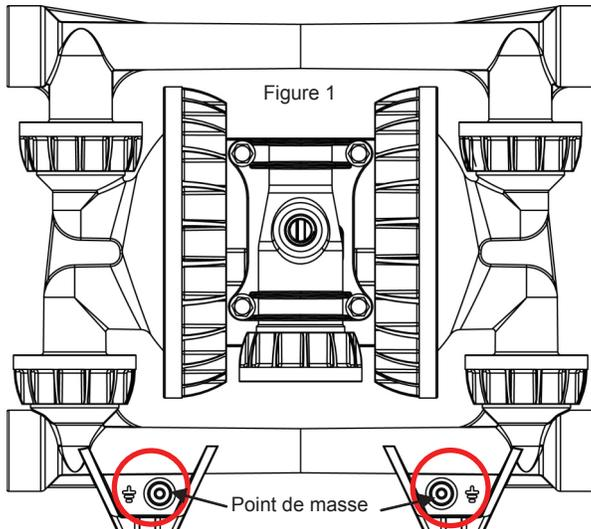
La pompe à membrane pneumatique SP100 peut être raccordée à la terre par l'intermédiaire du pied de fixation situé sur le manifold d'arrivée (Figure 1). Pour réduire le risque d'étincelle statique, raccordez à la terre la pompe et tout le matériel situé dans la zone de pompage. Les fils de mise à la terre doivent être de calibre adéquat et installés conformément aux codes de l'électricité locaux et nationaux.
