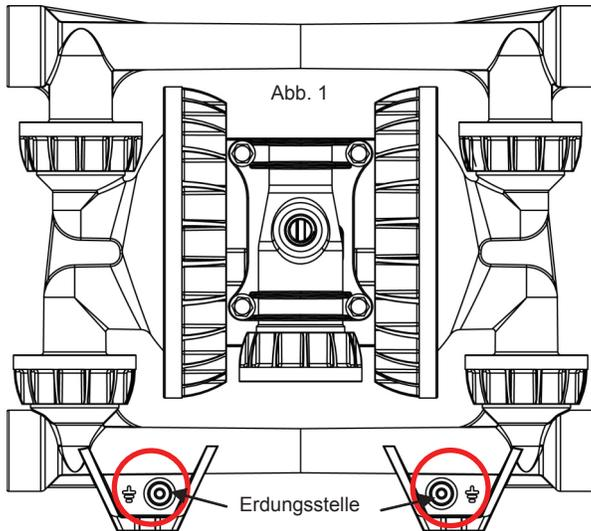
Die SP100 Pumpe kann durch die Montagefüße am Einlassverteiler (Abb. 1) geerdet werden. Zur Verringerung des Risikos statischer Funken müssen die Pumpe und alle anderen Ausrüstungen im Bereich des Pumpsystems geerdet sein. Massedrähte müssen ausreichenden Durchmesser haben und gemäß lokalen und nationalen Elektrikvorschriften installiert werden.
