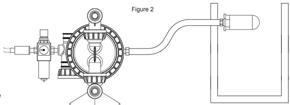
Il est également important de placer l'extrémité de la tuyauterie d'évacuation dans un récipient adéquat pouvant contenir tout liquide rejeté (Figure 2).
