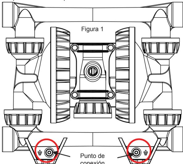
La bomba SP100 se puede conectar a tierra a través de las patas de montaje, ubicadas en el múltiple de entrada (Figura 1). A fin de reducir el riesgo de chispas de electricidad estática, conecte a tierra la bomba y todos los otros equipos ubicados en el área de bombeo. Los cables de conexión a tierra deben ser del tamaño adecuado y se deben instalar según los códigos eléctricos locales y nacionales.
