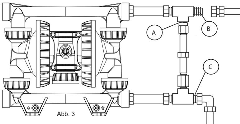
Bei einigen Systemen muss eventuell im Pumpenauslass ein Druckentlastungsventil eingebaut werden, um zu hohem Druck und ein mögliches Bersten der Pumpe oder des Schlauchs zu vermeiden (Abb. 3).
