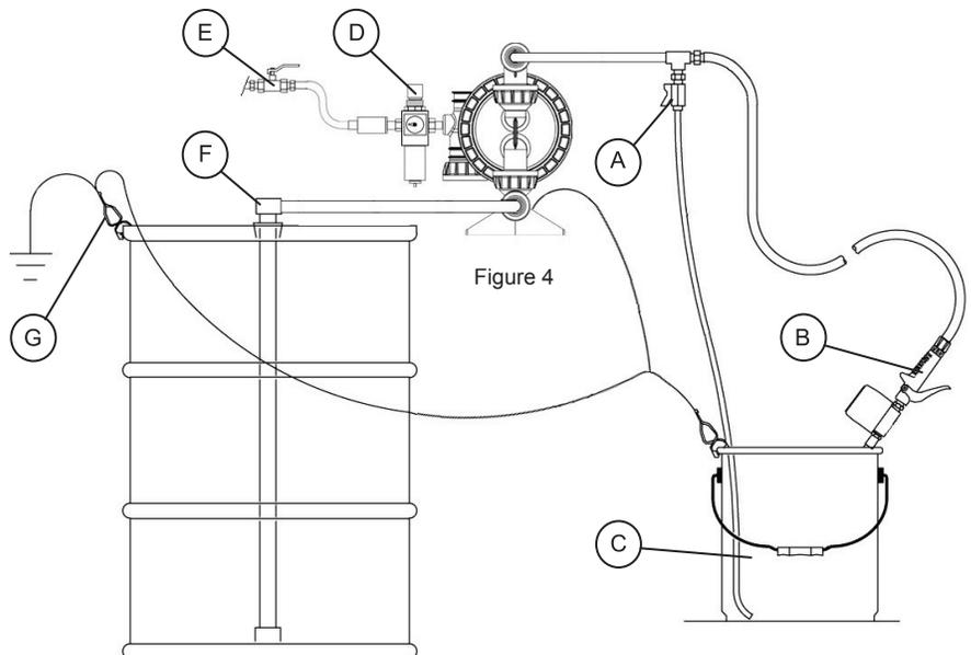
**AVERTISSEMENT** **AVERTISSEMENT ! ARRÊT APPROPRIÉ DE LA POMPE !** La durée de vie de la membrane et des joints peut être réduite si une pression d'air s'exerce sur le moteur pendant de longues périodes quand la pompe n'est pas utilisée. La pose d'une électrovanne à trois voies relâchant automatiquement la pression exercée sur le moteur quand un cycle de comptage est terminé empêche ceci de se produire.
