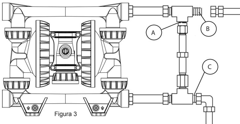
Es posible que algunos sistemas requieran la instalación de una válvula de alivio de presión en la salida de la bomba para evitar el exceso de presión y la posible ruptura de la bomba o la manguera (Figura 3).
