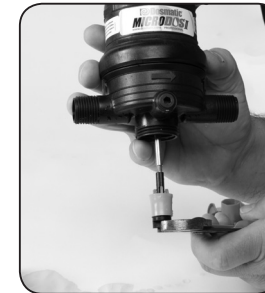
Paso 2. Desenrosque el eje inferior N°52 con la llave (no incluida con la unidad).
