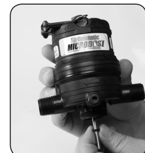
Paso 5. Reemplace el O-ring N°17 y coloque nuevamente y ajuste el TUERCA DE SOPORTE PARA O-ring N°88 con la llave 6 en 1 de Dosmatic.
