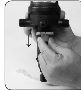
Paso 1. Desenrosque el CILINDRO EXTERIOR N°7 del cuerpo con la llave 6 en 1 de Dosmatic (incluida con la unidad).
