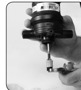
Paso 6. Reinserte del EJE INFERIOR N°52, ajuste con la llave 6 en 1.
