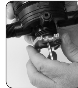
Paso 4 Quite la TUERCA DE SOPORTE PARA O-ring N°88 con la llave 6 en 1 de Dosmatic.
